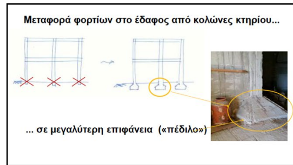
Σχήμα 1: Δύο διαφάνειες από το πρώτο μέρος του βιντεομαθήματος: σχέση μεταξύ βάρους, επιφάνειας στήριξης-θεμελίωσης (παπούτσι, ταψί, πέδιλο με τακούνι, πέδιλο κτηρίου) και συμπίεσης.
