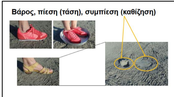
Σχήμα 1: Δύο διαφάνειες από το πρώτο μέρος του βιντεομαθήματος: σχέση μεταξύ βάρους, επιφάνειας στήριξης-θεμελίωσης (παπούτσι, ταψί, πέδιλο με τακούνι, πέδιλο κτηρίου) και συμπίεσης.
