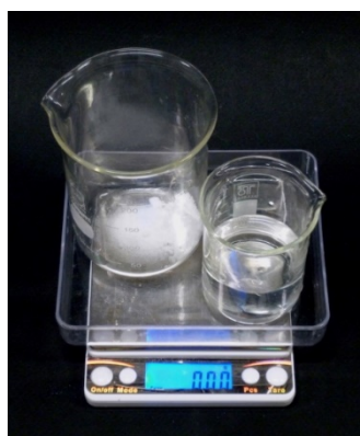
Εικόνα 1: Προσδιορισμός μεταβολής μάζας στο ζυγό
