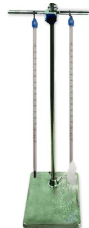
Αντίστοιχα των επιστημονικών οργάνων εκπαιδευτικά υγρόμετρα (τριχός, διυλικής σπείρας και υγρού και ξηρού - θερμομέτρου αντίστοιχα)
